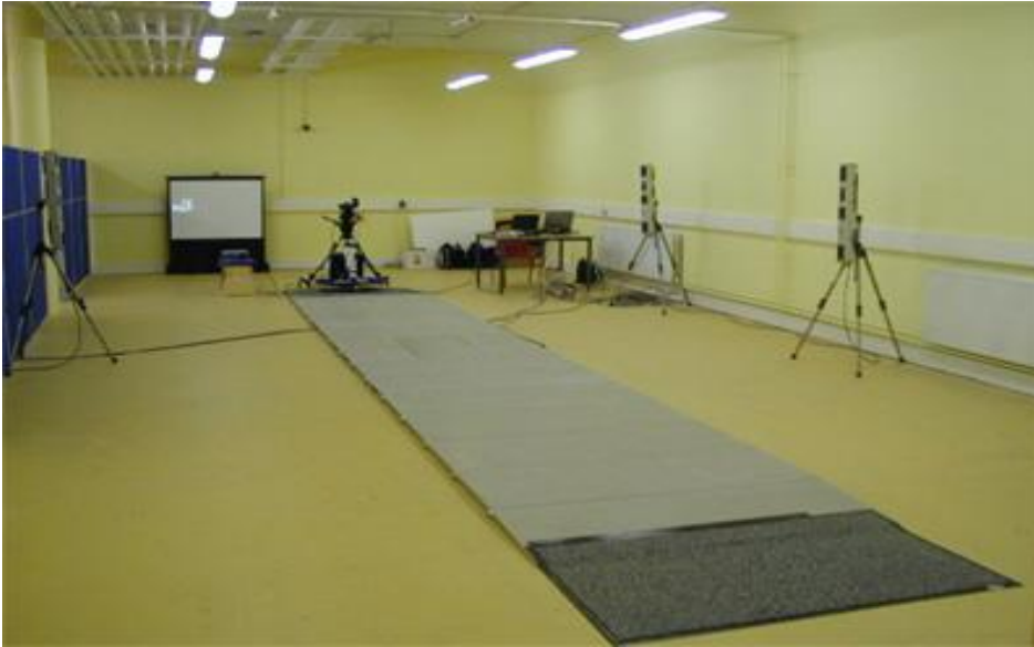
Εικόνα 3.3 Εργαστήριο τριδιάστατης ανάλυσης βάδισης (3DGA) (Τροποποιημένη από Yavuzer G. Three – dimensional quantitative gait analysis 2009;43(2)95).
