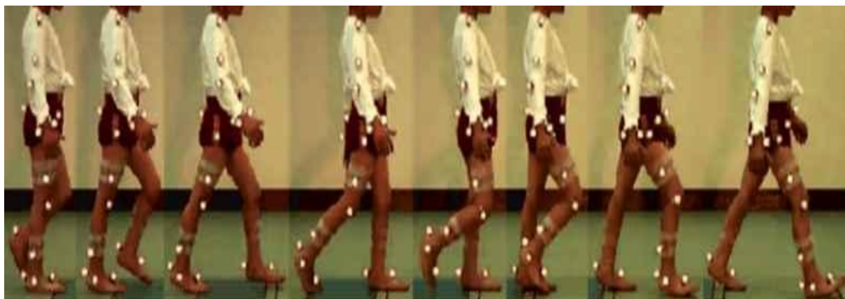
Εικ. 3.4: Χρήση τρισδιάστατης κάμερας και οπτικών αισθητήρων για ανάλυση βάδισης (Μορφοποίηση από http://www.frontiernet.net/ )
