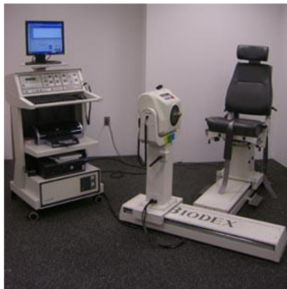
Εικόνα 2.3 Ισοκίνητικό δυναμόμετρο Biodex system 3 (τροποποιημένο από www.keanathletics.com )
