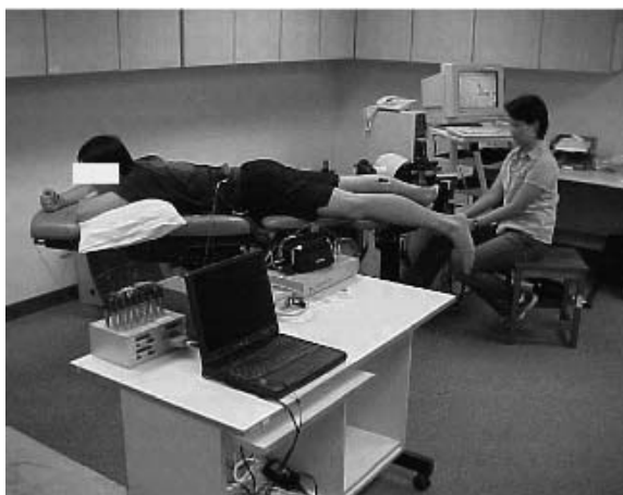
Εικόνα 3.12. Πειραματική εφαρμογή για τη δοκιμή παθητικής επανατοποθέτησης της ποδοκνημικής άρθρωσης. Οι εξεταζόμενοι ξάπλωναν σε πρηνή θέση με την ποδοκνημική σε 90^\circ ραχιαίας κάμψης και τον πρόσθιο άκρο πόδα τοποθετημένο στη βάση ενός δυναμόμετρου Cybex Norm (από Amy Fu and Christina Hui-Chan, 2005).
