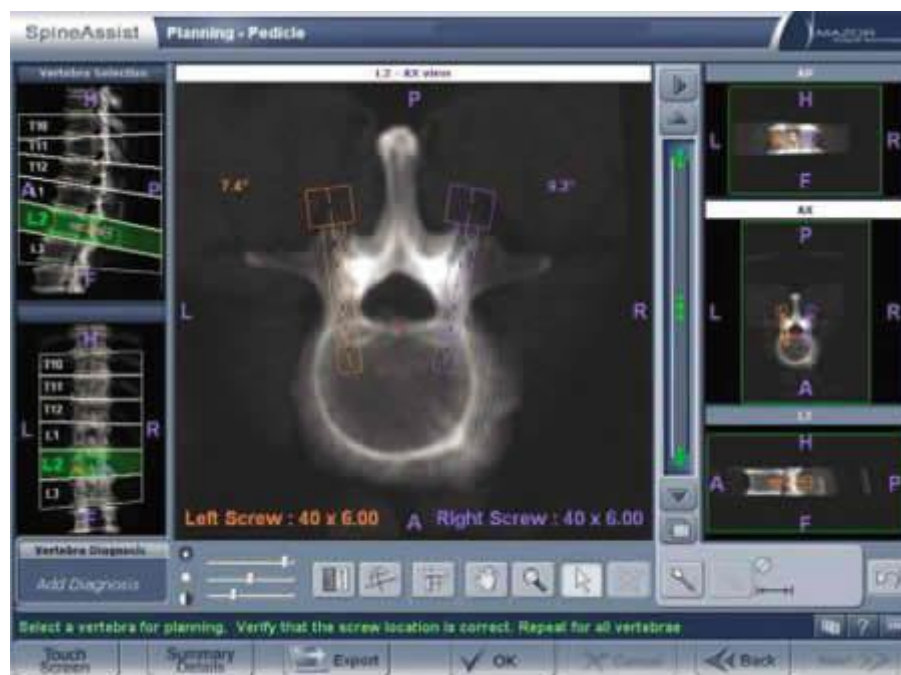
Εικόνα 2.2 Σχεδίαση της επιθυμητής θέσης των βιδών στον ηλεκτρονικό υπολογιστή στον οποίο έχει εισαχθεί η αξονική τομογραφία του ασθενούς.
