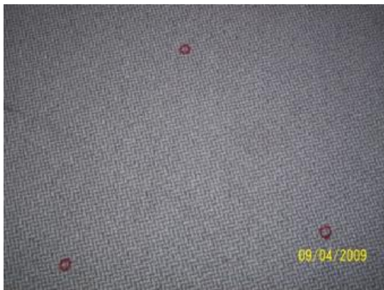
Εικόνα 5.7. Σε αυτή την εικόνα φαίνονται τα σημεία ακριβούς τοποθέτησης του τριπόδου στο έδαφος
