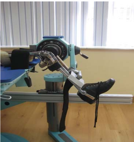
Εικόνα 3.6. Μηροκνημοποδικός κηδεμόνας, ο οποίος τοποθετήθηκε στο ισοκινητικό μηχανήμα τύπου CON-TREX, με σκοπό την μέτρηση αξιοπιστίας του ερευνητή.
