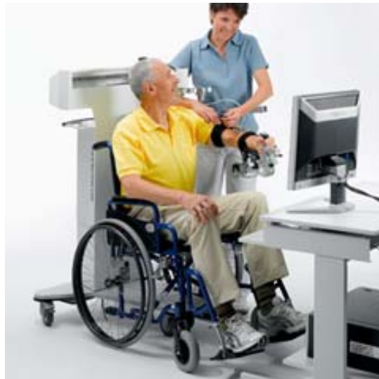
Εικόνα 3.3 Χρήση ρομποτικού άνω άκρου για την αποκατάσταση της λειτουργικότητας( τροποποιημένο από www.Hocoma.com )
