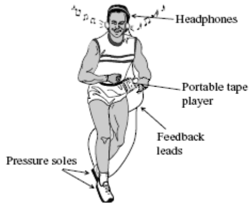
Εικ. 16. Η συσκευή MMF αποτελείται από σόλες παπουτσιών με αισθητήρες, οι οποίοι εντοπίζουν την επαφή των φτερνών με το έδαφος. Αυτοί οι αισθητήρες συνδέονται με ηλεκτρικά άκρα με ένα φορητό μαγνητόφωνο, το οποίο είναι συμβατό με το πρότυπο MIDI (Musical Instrumental Digital Interface). Η μουσική ξεκινά και ελέγχεται από τα χτυπήματα των φτερνών ή άλλα σημάδια πίεσης, τα οποία παράγονται από τους αισθητήρες πίεσης και επιτρέπουν στον ασθενή να τροποποιεί την βάρδια του ώστε να ακούει την μουσική της επιλογής του. (Τροποποιημένο από Schauer et al. 1996).
