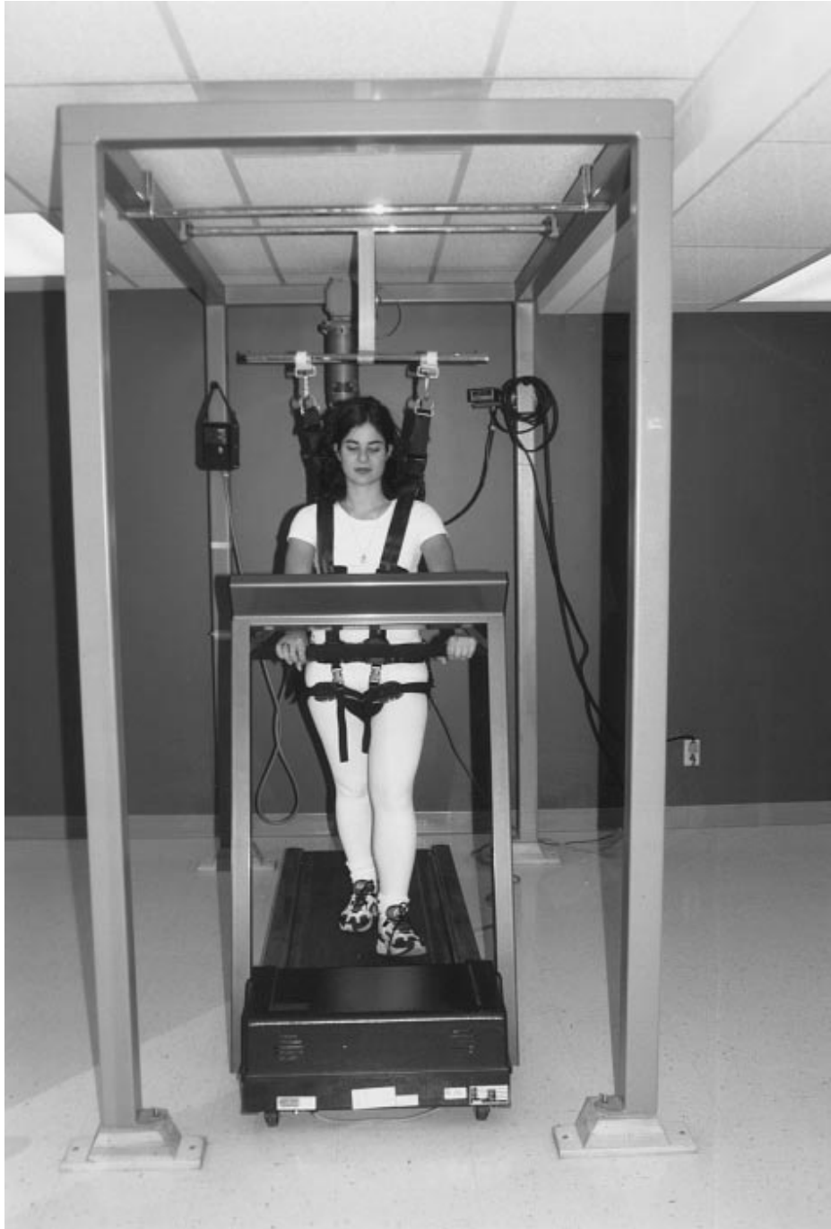
Εικ. 11. Το σύστημα στήριξης του σωματικού βάρους που αποτελείται από σύστημα ανάρτησης και μάντες, οι οποίοι στηρίζουν το άτομο κάθετα πάνω από τον διάδρομο (Τροποποιημένο από M. Visintin et al, 1998).
