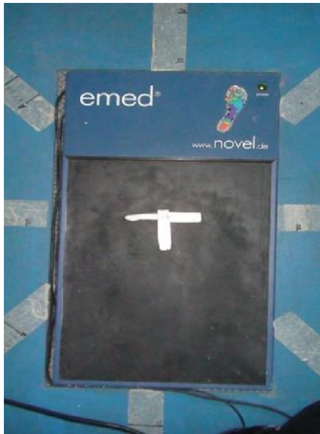
Εικ. 2.1: Αισθητική επιφάνεια πελματογράφου EMed
