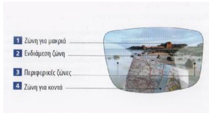
Εικόνα 3.2 : Σχεδιασμός ενός πολυεστιακού οφθαλμικού φακού
