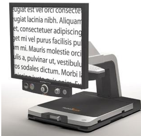
Εικόνα 130: Κλειστό κύκλωμα τηλεόρασης
