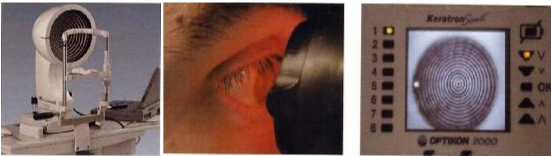
Εικόνα 37: Αριστερά επιτραπέζιος τοπογράφος. Στη μέση οι ανακλάσεις του Placido disk του τοπογράφου στον κερατοειδή, και δεξιά η εικόνα μέσα από την κάμερα του τοπογράφου.
