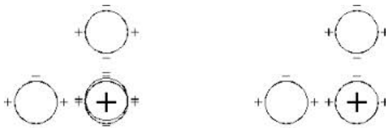
Εικόνα 4.10.: Τα είδωλα του κερατόμετρου στην αριστερή εικόνα όταν είναι εκτός εστίας και στην δεξιά όταν η εστίαση είναι καλή
