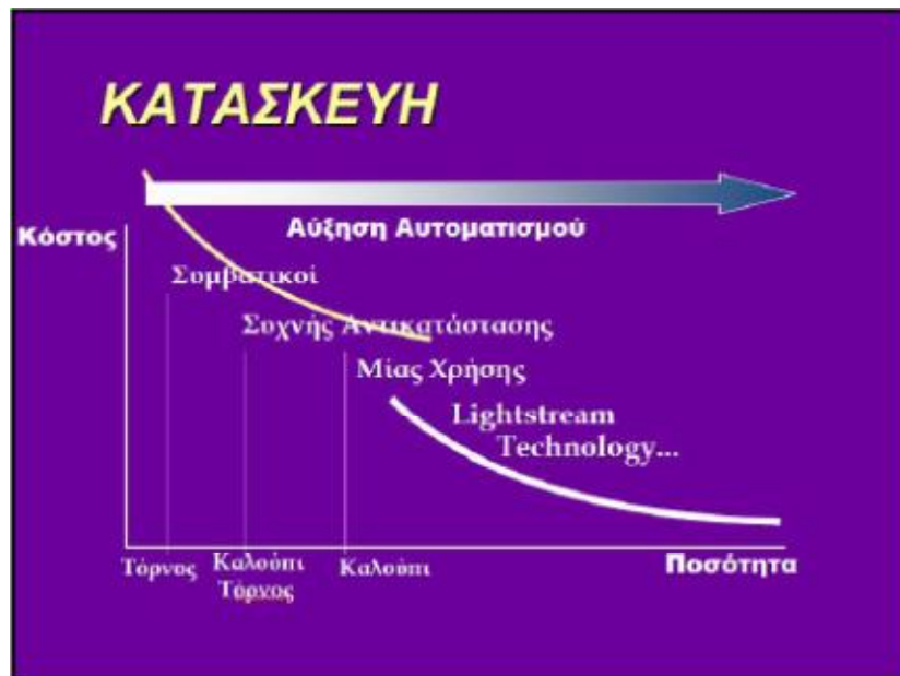
Εικόνα 4.1: Αναλογία μεταξύ κόστους και ποσότητας παραγωγής φακών επαφής από 4 μεθόδους κατασκευής. Κάθε μέθοδος παράγει φακούς με βάση τη χρονική τους αντικατάσταση. Όσο μεγαλύτερος είναι ο αυτοματισμός της εκάστοτε μεθόδου, τόσο αυξάνεται η ποσότητα, ενώ το κόστος μειώνεται σημαντικά (Lightstream Technology – Dailies, Ciba Vision) [27-34].
