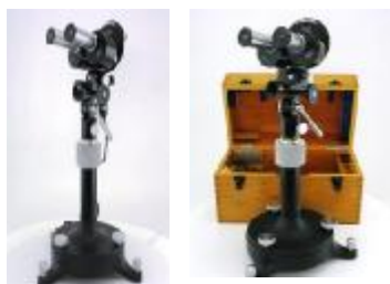
Εικόνα 9: Ιστορική λυχνία Gullstrand από την εταιρεία Zeiss
