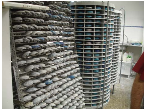
Εικόνα 4: Τα 9.000 καλούπια τοποθέτησης των οφθαλμικών φακών στην επιχείρηση ΒΑΙΡΑΜΟΓΛΟΥ ΑΕΒΕ
