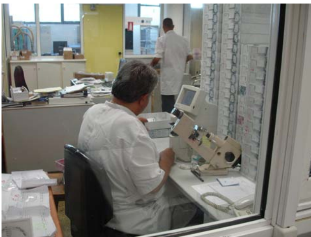
ΕΙΚΟΝΑ 8: Τελικός έλεγχος - φακομέτρηση.
