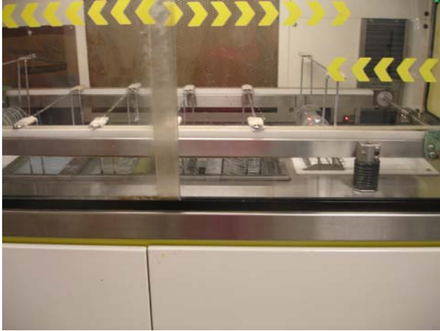
ΕΙΚΟΝΑ 6: SCL INTERNATIONAL. Μηχάνημα πρώτου ξεπλύματος των οφθαλμικών φακών. Χρησιμοποιείται ισχυρή βάση (σαπούνι), ασθενές οξύ, νερό βρύσης και τέλος απιονισμένο νερό.
