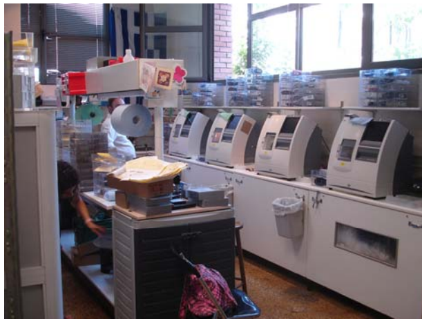
ΕΙΚΟΝΑ 13: Τελικός έλεγχος και κοπή φακών σύμφωνα με τους σκελετούς και τις παραγγελίες που έχουν στείλει τα καταστήματα.
