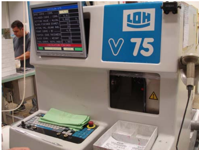
Εικόνα 3:Μηχανή κοπής(Generator). Πραγματοποιεί ημιεπεξεργασία των οφθαλμικών φακών.
