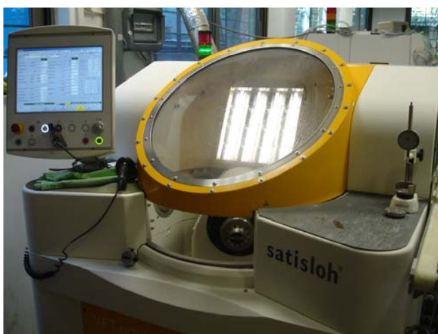
Εικόνα 5: Υπερσύγχρονη μηχανή κοπής των οφθαλμικών φακών(Satisloh), όπου η κοπή πραγματοποιείται με διαμάντι.
