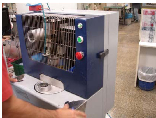
Εικόνα 1: Το σύγχρονο μηχάνημα Taper έναρξης της επεξεργασίας των οφθαλμικών φακών.
