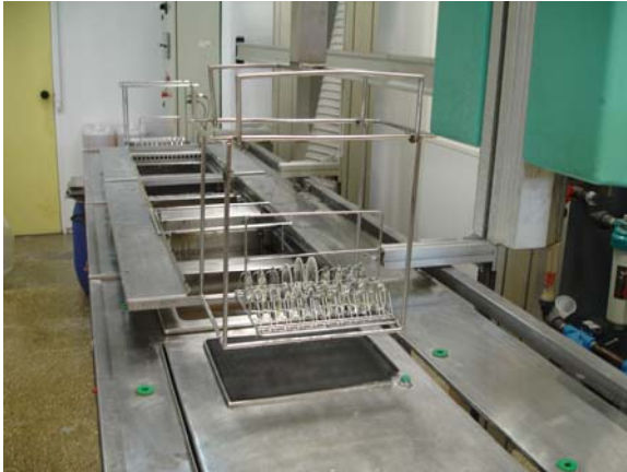
ΕΙΚΟΝΑ 9: Πολλαπλά πλυσίματα φακών. Χρήση υπερήχων - Μηχανισμός απιονισμένου νερού.
