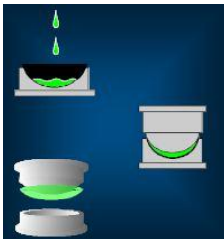
Εικόνα 18 : Κατασκευή με τη μέθοδο της χύτευσης σε καλούπι (13)
