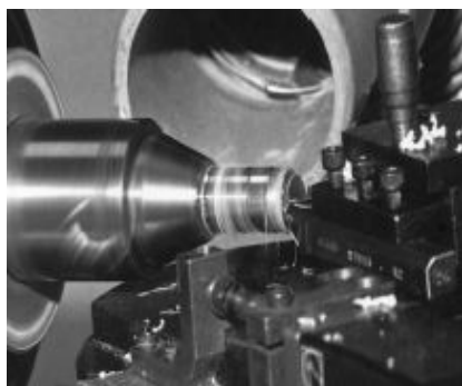
Εικόνα 16 : Κατασκευή φακού επαφής σε τόρνο (2)
