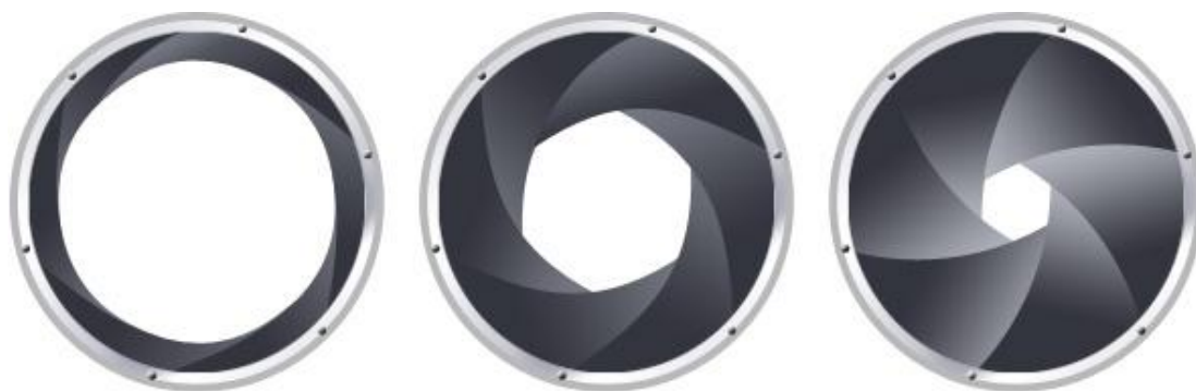
Απεικόνιση των τιμών f/2, f/8 και f/22 ενός μηχανισμού διαφράγματος
