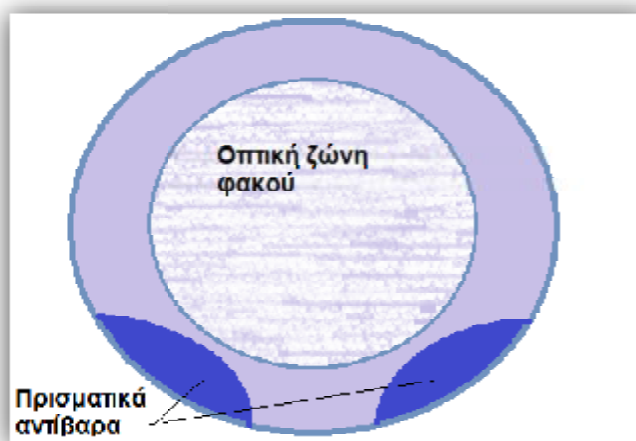
Εικόνα 15 Σχεδιασμός αστιγματικού φακού με πρισματικά αντίβαρα παραπλεύρως
