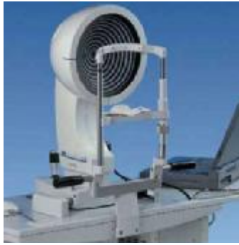
Σχήμα 3.12 : Τοπογράφος με μεγάλο κώνο για μέτρηση χωρίς επαφή με το μάτι του εξεταζόμενου.
