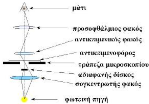
Σχήμα 2.6: Διάγραμμα της διάταξης των φακών και της πορείας των φωτεινών ακτινών στο μικροσκόπιο σκοτεινού πεδίου.
