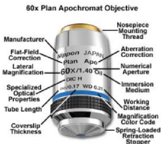
Σχήμα 2.19: Υπομνημα επεξήγησης συμβόλων επάνω στο σώμα των φακών
