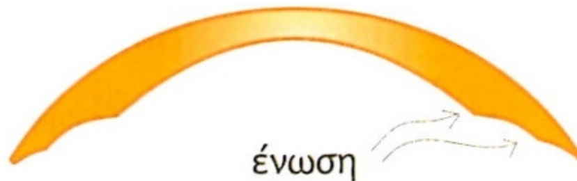
Εικόνα 1.23: Τρικαμπυλωτός φακός επαφής με 3 διαφορετικές ακτίνες καμπυλότητας. Οι πολυκαμπυλωτοί φακοί έχουν συνήθως 4 ή 5 διαφορετικής ακτίνας καμπυλότητας επιφάνειες (ζώνες) (από: Κατσούλος & Μακρυνιώτη, 2010).
