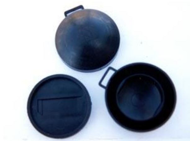
Εικόνα 8: Δοσίμετρα που χρησιμοποιεί η ΕΕΑΕ για τη μέτρηση ραδονίου στο σπίτι
