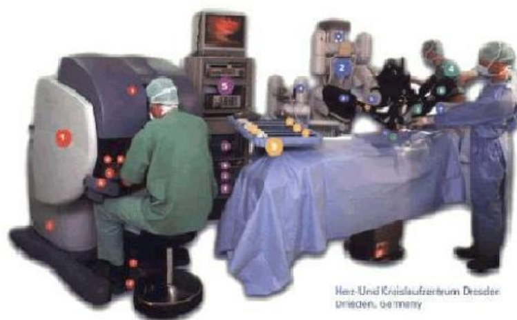
Εικόνα 2. Εγχείρηση αορτοστεφανιαίας παράκαμψης με το σύστημα da Vinci. 1. Χειρουργική κονσόλα 2. Ρομποτικό σύστημα, 3. Δίσκος εργαλείων, 4. Ρομποτικοί βραχίονες, 5. Πύργος ενδοσκοπικής εικόνας.
