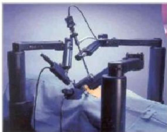
Εικόνα 3. Οι βραχίονες του ρομποτικού συστήματος Zeus.
