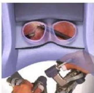
Εικόνα 4. Το τρισδιάστατο εικονικό πεδίο που παρακολουθεί στην κονσόλα ο χειρουργός και τα εργαλεία με τα οποία ελέγχει τους ρομποτικούς βραχίονες στο σύστημα DaVinci.
