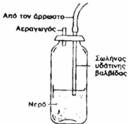
Εικόνα Συσκευή θωρακικής παροχέτευσης μιας φιάλης (συλλογής υγρού και βαλβίδας νερού).
