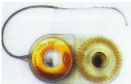
Εικόνα 3.20 – Δέκτης-διεγέρτης κοχλιακού εμφυτεύματος τύπου HIRES 90K (Advance Bionics).
