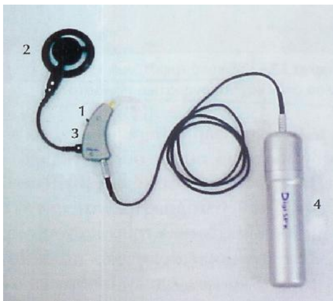
Εικόνα 3.10 – Εξωτερικό τμήμα του κοχλιακού εμφυτεύματος.
