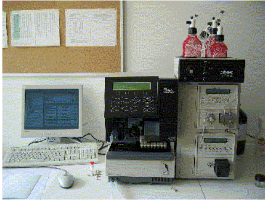
Μικρο- και Νανο HPLC συμπιεσμένο σύστημα με Αυτόδειγμα
