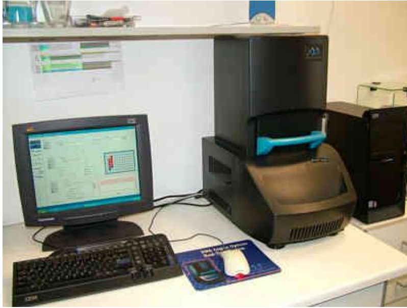
Μηχανή θερμικού κύκλου πραγματικού χρόνου (μηχανή PCR) DNA οπτική μηχανή
