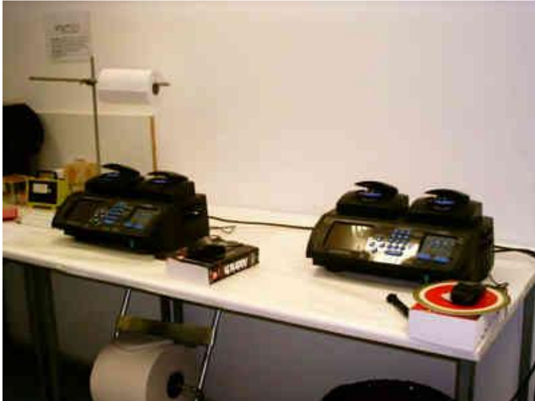
Μηχανές 7 θερμικών κύκλων (PCR μηχανές), AB, MJ Έρευνα, Stratagene
