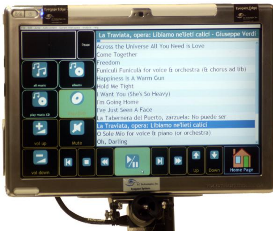
Εικόνα 4.2.2 Eyegaze Edge AMDI. Ο μηχανισμός ανίχνευσης της κίνησης των ματιών βρίσκεται στη βάση της οθόνης και μοιάζει με κάμερα.
