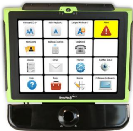
Εικόνα 4.2.3 EyeMax Dynavox. Στη βάση της οθόνης υπάρχει ο μηχανισμός ανίχνευσης της κίνησης των ματιών
