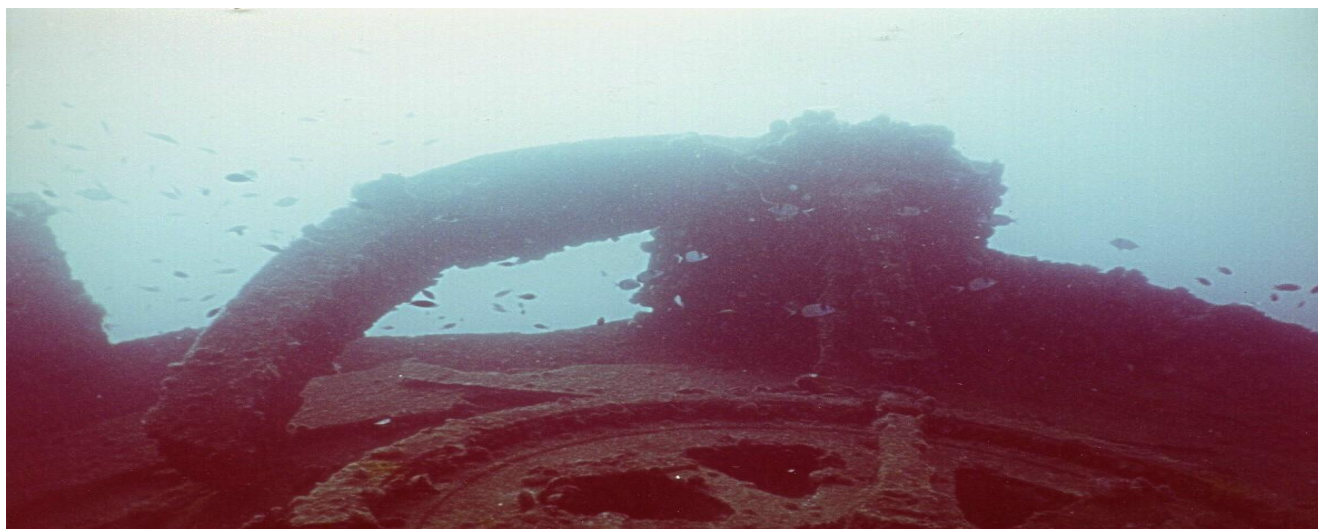
III.4. Η πρόμνη του «ΝΕΣΤΟΣ» διακρίνεται ότι έχει απομείνει από τον μηχανισμό περισυλλογής των ναρκών.
