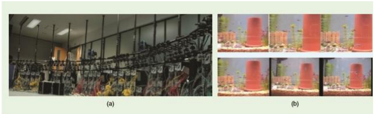
Εικόνα 2.11 Ένα σύστημα σύλληψης και η δημιουργία πολλαπλών απόψεων σε ένα FTV περιβάλλον. (Πηγή: IEEE SIGNAL PROCESSING MAGAZIN, NOVEMBER 2007)
