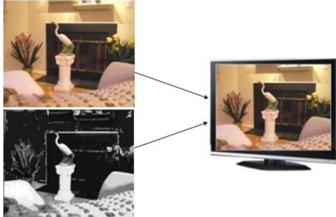
Εικόνα 3.12 Αναγέννηση του στερεοφωνικού βίντεο από το σήμα V+D. (Πηγή: Daniel_Minoli_3DTV, 2010 JohnWiley&Sons, Inc.)
