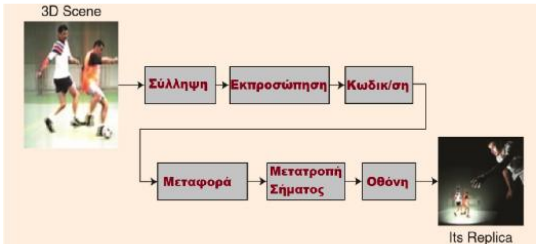
Εικόνα 2.25 Λειτουργικές μονάδες σε μια πιθανή end-to-end 3DTVαλυσίδα
