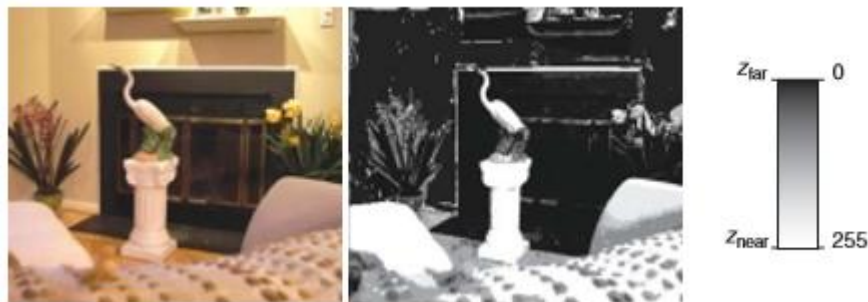
Εικόνα 3.11 Video plus depth (V+D) εκπροσώπηση για 3DV. (Πηγή: Daniel_Minoli_3DTV, 2010 John Wiley&Sons, Inc.)
