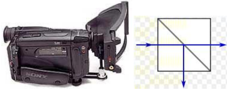
Εικόνα 2.9 τρισδιάστατος προσαμογέας (3d lens adapter), τριγωνικά γυάλινα πρίσματα
