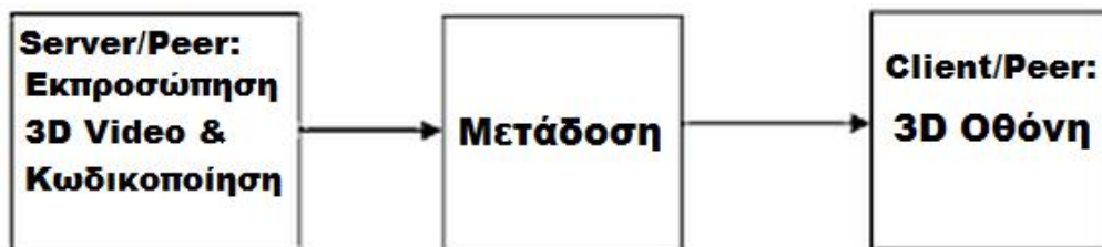
Εικόνα 4.1 διάγραμμα ενός συστήματος 3DTV από άκρο σε άκρο
