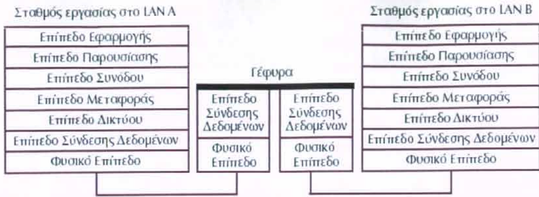
Σχήμα3.6 Λειτουργία της γέφυρας σε σχέση με τα επίπεδα του OSI μοντέλου
