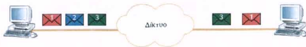
Σχήμα1.6 Στην υπηρεσία χωρίς σύνδεση τα πακέτα μεταφέρονται με τυχαία σειρά και δεν υπάρχει εγγύηση ότι θα παραληφθούν χωρίς λάθη
