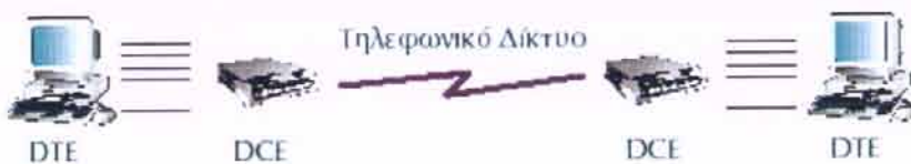
Σχήμα 3.1 Συνδεσμολογία των συσκευών DTE&DCE
