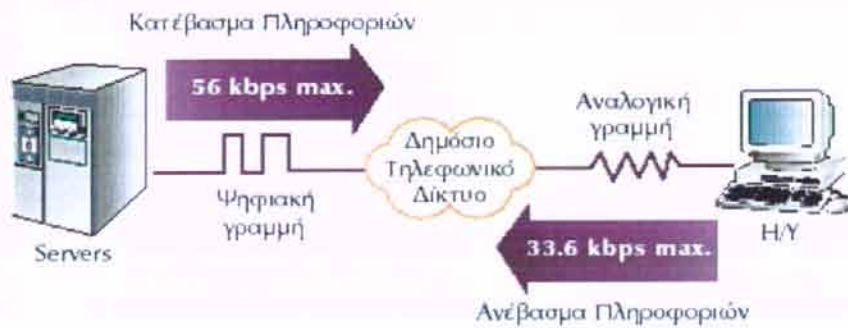
Σχήμα 3.3 Σύνδεση υπολογιστών με V90 modem, σε παροχέα υπηρεσιών διαδικτύου, κάνοντας χρήση του δημόσιου τηλεφωνικού δικτύου (α) Τοπολογία διασύνδεσης (β) Μετατροπές A/D ή D/A που γίνονται στο σήμα εάν χρησιμοποιούνται modem V90 ή V34 (γ) Απεικόνιση της ασυμμετρικής σύνδεσης στην περίπτωση χρησιμοποίησης V90 modems
