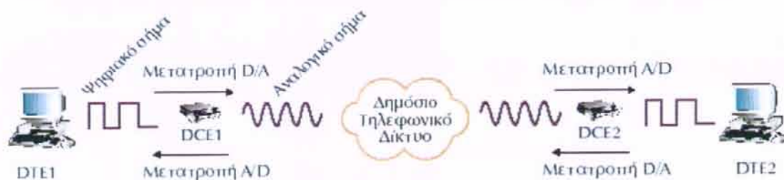
Σχήμα 3.2 Επικοινωνία τερματικών συσκευών DTEs με χρήση modems μέσω του δημόσιου τηλεφωνικού δικτύου
