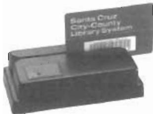
Οι ανιχνευτές διακριτικών αυλακώσεων απαιτούν μόνο ένα χέρι για τη λειτουργία τους. Ο χρήστης γλιστρά απλά το διακριτικό του με έναν κώδικα φραγμών στην κατώτατη άκρη μέσω του ανιχνευτή. Αυτοί χρησιμοποιούνται χαρακτηριστικά στους αφύλακτους σταθμούς εισόδου/εξόδου για τη μισθοδοτική κατάσταση, λογιστι-
