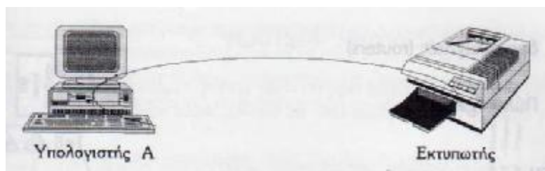
Σχήμα 1.3.2 Σύνδεση υπολογιστή – εκτυπωτή που δεν είναι σε δίκτυο
