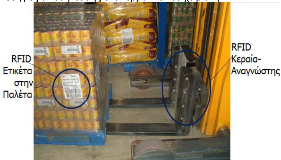
Εικόνα 29: Τοποθέτηση RFID Εξοπλισμού στο Περονοφόρο
