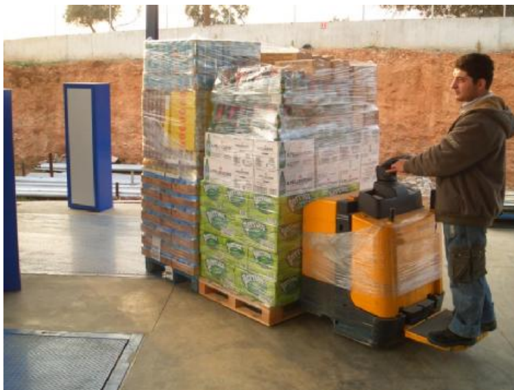
Εικόνα 20: Αυτόματη Αναγνώριση Παλετών μέσω RFID πύλης
