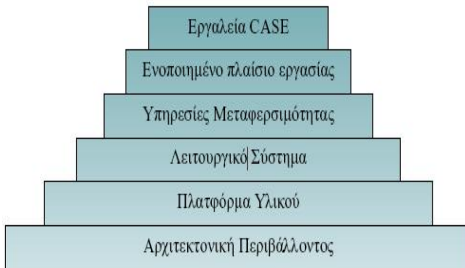
Σχήμα 2.24 Ιεραρχία εννοιών αναφοράς της τεχνολογίας CASE
