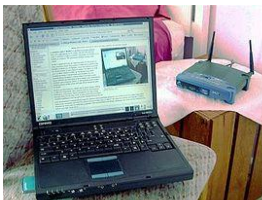
Εικόνα 1.3: Ένας φορητός υπολογιστής που επικοινωνεί ασύρματα, μέσω ραδιοκυμάτων, με ένα σημείο πρόσβασης το οποίο συνδέεται στο Internet ή σε κάποιο ασύρματο LAN.
