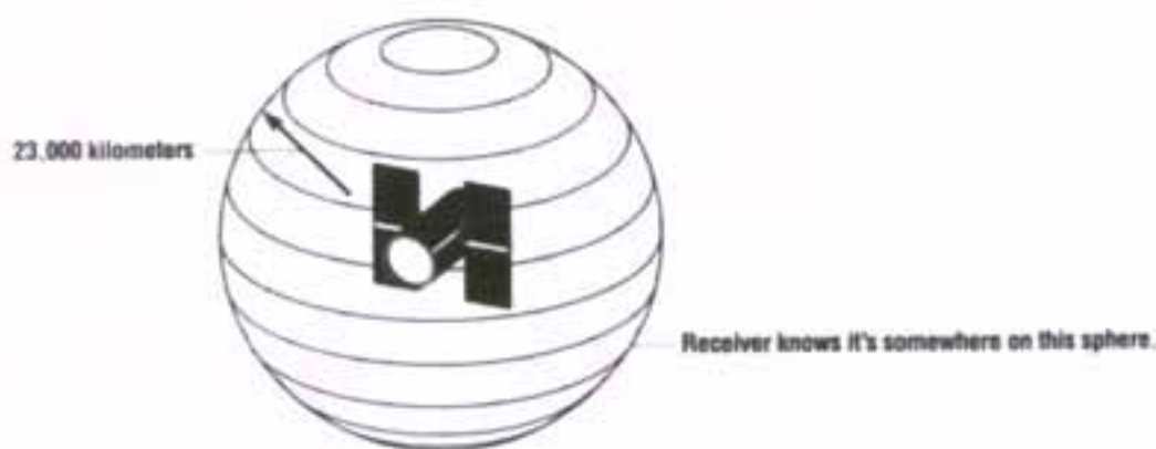
Εικόνα 20: Με την πρώτη μέτρηση ο δέκτης GPS περιορίζει την πιθανή θέση του στην επιφάνεια μιας φανταστικής σφαίρας, στην προκειμένη περίπτωση ακτίνας 23000 km
