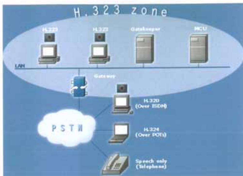
Σχήμα 2. Ο ρόλος του ελεγκτή πύλη πρόσβασης σε μία ζώνη H323 29
