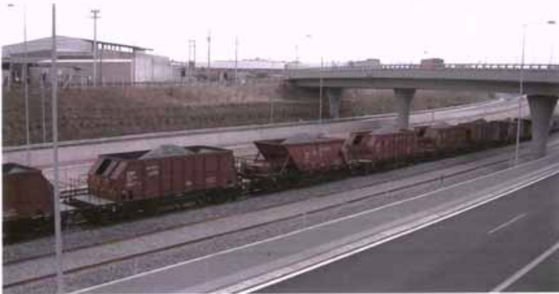
Εικόνα: Μεταφορά σκύρων με σκυροβάνονα
