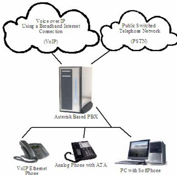
Σχήμα 5.12.4: Περιγραφή του τρόπου με τον οποίο συνδέεται με το hardware ένα PBX που βασίζεται στο Asterisk.
