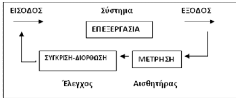
Σχήμα 3.1.2: Σύστημα ελεγχόμενο με ανατροφοδότηση
