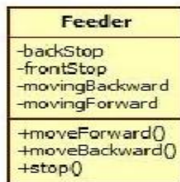
Εικόνα 10: Η κλάση Feeder
