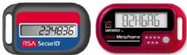
Εικόνα 84. Tokens παραγωγής κωδικών μίας χρήσης. Ο κωδικός που ισχύει κάθε φορά αλλάζει κάθε λίγα δευτερόλεπτα
