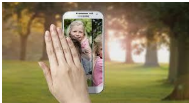
Εικόνα 45 : Εφαρμογή AirGesture στην οποία εναλλάσσεται μια εικόνα με την επόμενη με το πέρασμα της παλάμης πάνω από την οθόνη
