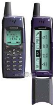
Εικόνα 12 : Ericson R380 , το πρώτο κινητό στο οποίο αναπτύχθηκε και εφοδιάστηκε με λειτουργικό σύστημα τύπου Symbian
