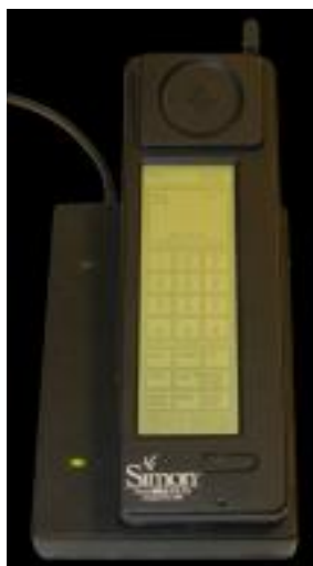
Εικόνα 5 : Bell South/IBM Simon Personal Communicator , το πρώτο κινητό τηλέφωνο με οθόνη αφής
