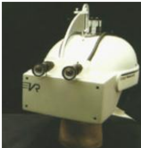
Ένα πραγματικό βίντεο see-through HMD, με δύο βιντεοκάμερες τοποθετημένες σ' ένα κράνος πτήσης[7]
