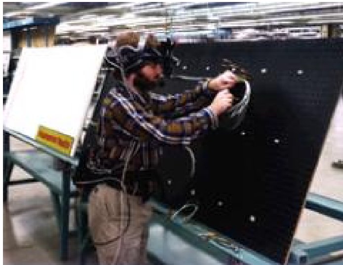
Ο Adam Janin χρησιμοποιεί ένα πρωτότυπο σύστημα Επαυξημένης Πραγματικότητας για την κατασκευή μιας δέσμης καλωδίων[7]
