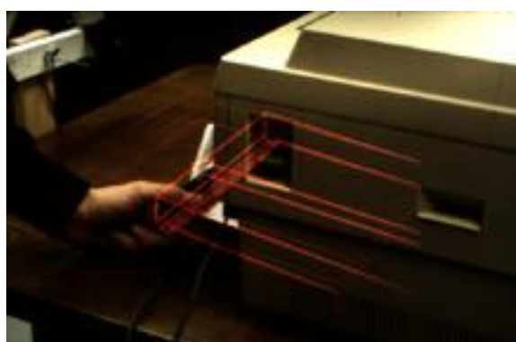
Εφαρμογή συντήρησης laser εκτυπωτών όπου εμφανίζεται ο τρόπος αφαίρεσης του δίσκου χαρτιού
