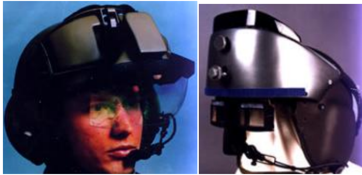
Δύο οπτικά see-through HMDs που κατασκευάστηκαν από την εταιρεία Hughes Electronics[7]
