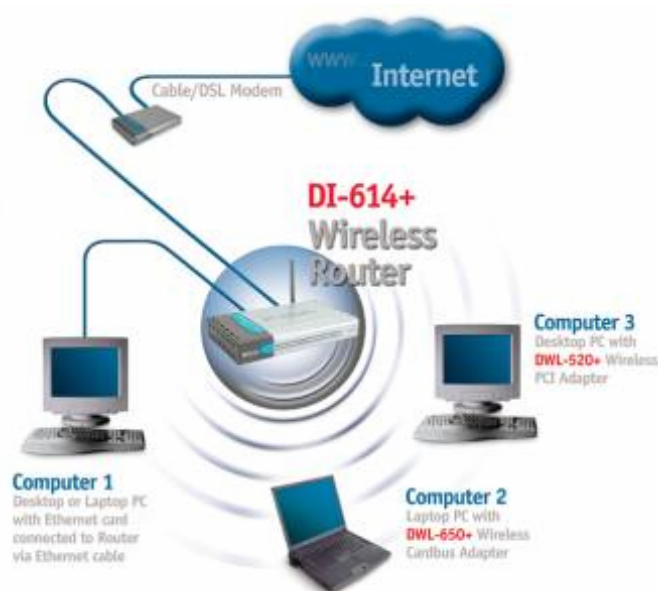
Εικόνα 11 : Τοπική σύνδεση τριών υπολογιστών μέσω ενός ασύρματου router
