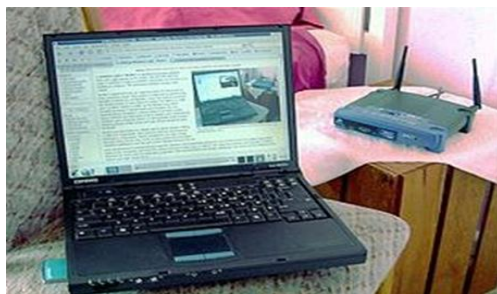
Εικόνα 1.1: Ένας φορητός υπολογιστής ο οποίος επικοινωνεί ασύρματα μέσω ραδιοκυμάτων με ένα σημείο πρόσβασης το οποίο συνδέεται στο internet
