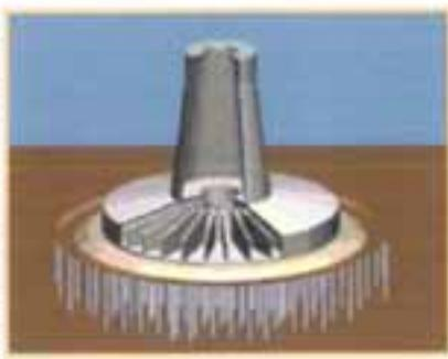
Πάνω από αυτόν υπάρχει μια ανεστραμμένη πυραμίδα ύψους περίπου 15 μ., με τετράγωνη βάση με πλευρές μήκους 38 μ. Κάθε πυλώνας αποτελείται από τέσσερα σκέλη από οπλισμένο σκυρόδεμα, διατομής 4X4 μ., που πακτώνονται στην κεφαλή του πυλώνα, σχηματίζοντας μια μονολιθική κατασκευή.
