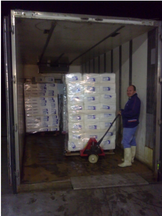
Εικόνα 25: Φόρτωση παλέτας σε φορτηγό - ψυγείο, με τη βοήθεια παλετοφόρου μηχανήματος.
