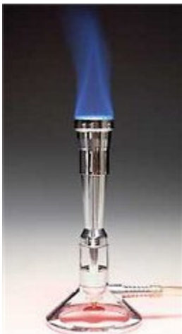
Το μεθάνιο (πάντοτε ως φυσικό αέριο) χρησιμοποιείται και ως αέριο καύσης για τους λύχνους Bunsen στα χημικά εργαστήρια.
